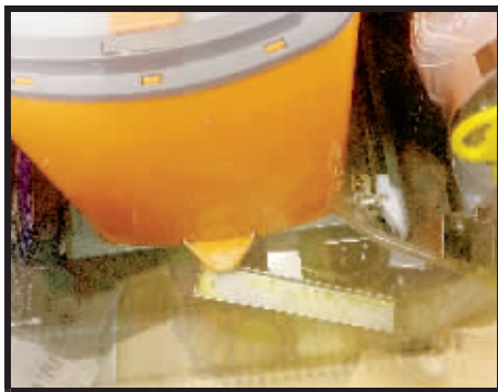
机器内壁和出汁口都残留污垢。
